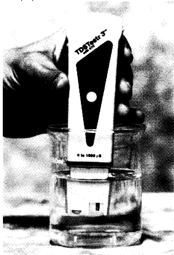
Рис. HYD-P-4. Использование прибора для измерения электропроводности
