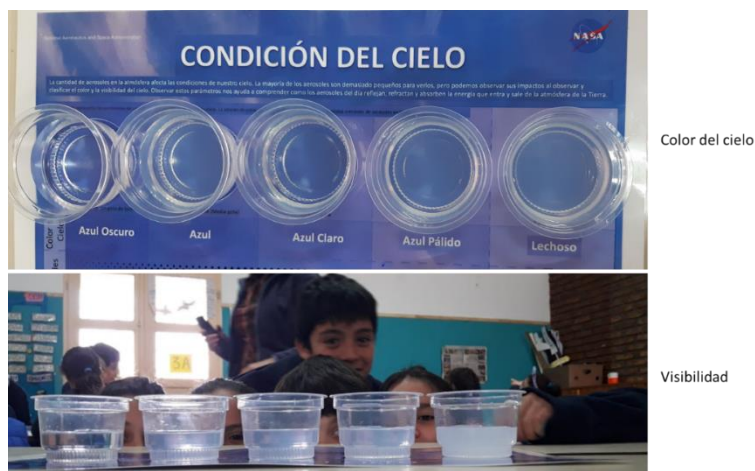
Fig. 9. Experimento de simulación de aerosoles. El agua simula la atmósfera y las gotas de leche los aerosoles. A mayor cantidad de gotas de leche “aerosoles” el color del cielo cambia de azul oscuro hasta lechoso (arriba). La visibilidad también disminuye con el aumento de la cantidad de “aerosoles” (abajo). NASA (2019b)
