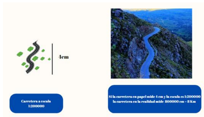
Figura 2: Escala de una carretera 1: 200000 es igual a decir que 1cm en el papel equivale a 200000 cm o 2 km en la realidad. Si la carretera mide en el papel 4cm entonces en la realidad esta mide 8 Km aplicando una regla de 3 simple: Escala = Dibujo / realidad
