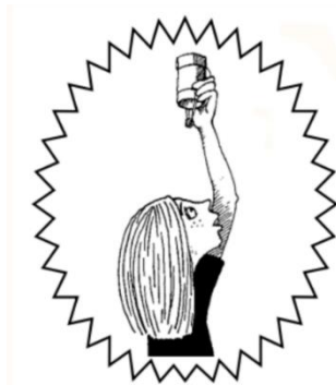
Figura 4: Para el uso del densiómetro el brazo del observador debe estar completamente estirado y la arandela debe de permanecer perpendicular hacia la cara del observador Fuente: Programa GLOBE
