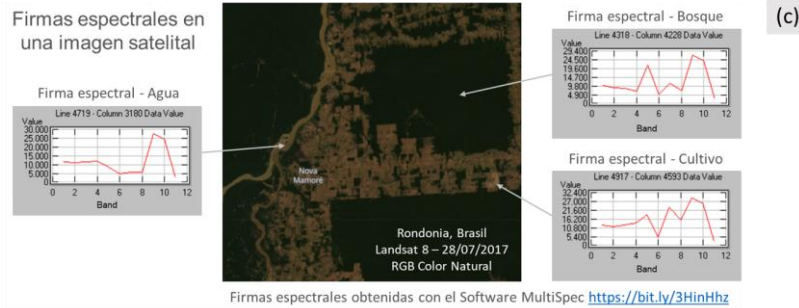
Fig. 3. Firmas espectrales: (a) de diferentes características de la Tierra. (b) de vegetación. (c) Ejemplos de firmas espectrales en distintos píxeles de la imagen satelital de Rondonia, tomada por el satélite Landsat 8 el 27/07/17.
