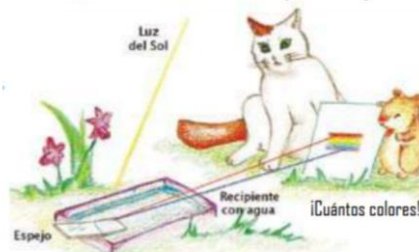
Figura 2: Experimento para observar la reflexión y descomposición de la luz Fuente: Barrientos y Martínez, 2011
